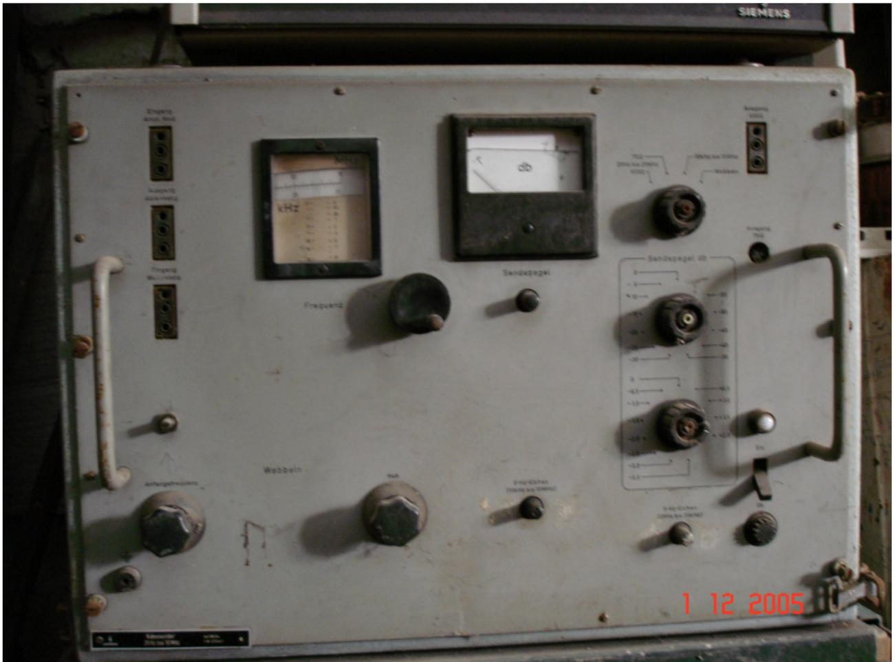
Tragbarer Videosender Rel 3W28c 20 Hz .. 20 Mhz in 2 Bereichen, 75 + 600 Ohm
