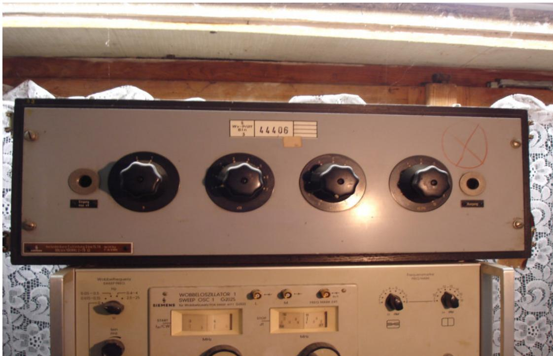
Rel 3D14a Veränderbare Eichleitung 0 bis 15,1 N Dämpfung, 0 Hz bis 100 Mhz,  $Z=70$  Ohm
