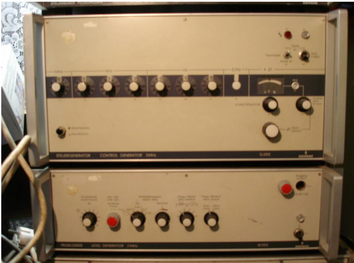
G2012 Steuergenerator 2 Mhz. Frequenz dekadisch einstellbar
