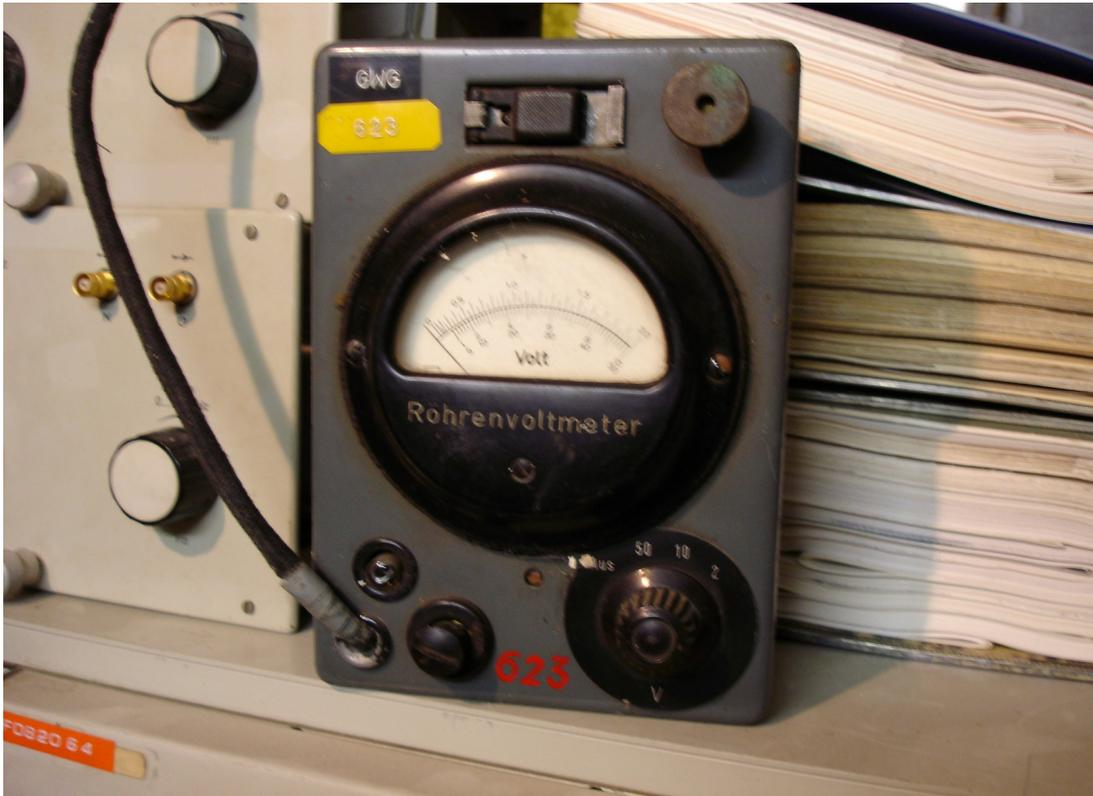
R&S Dezi Röhrenvoltmeter UDND ohne Tastkopf
