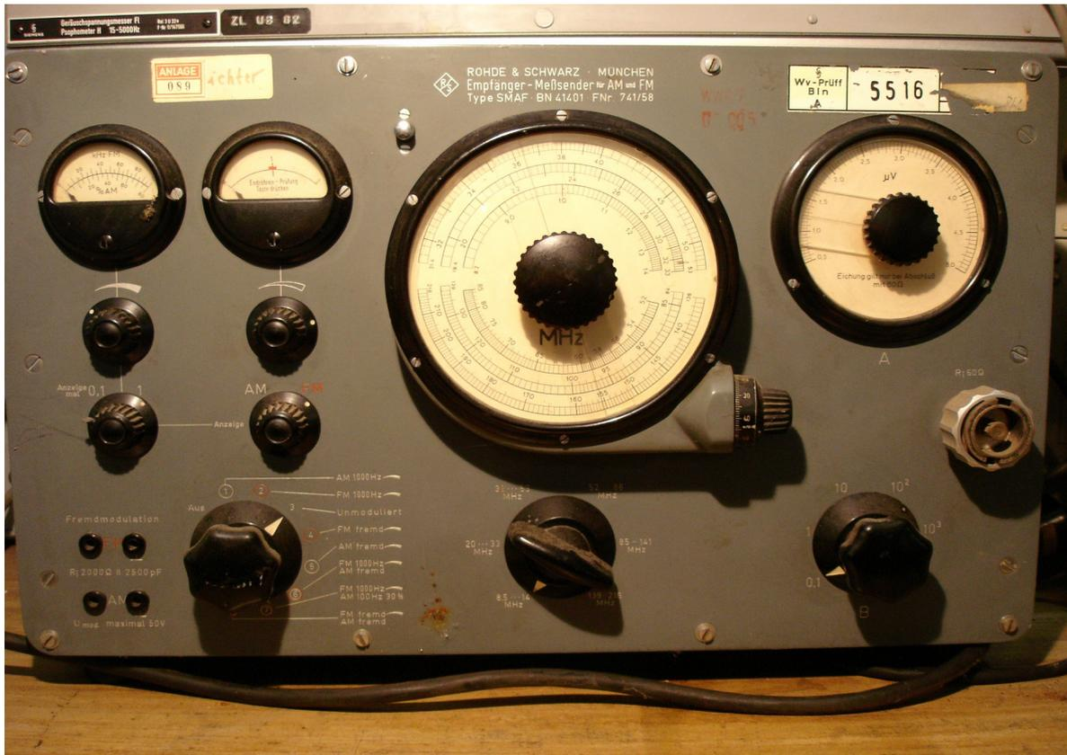
R&S SMAF Empfänger-Meßsender AM FM 8,5-215 Mhz, Z=60 Ohm
