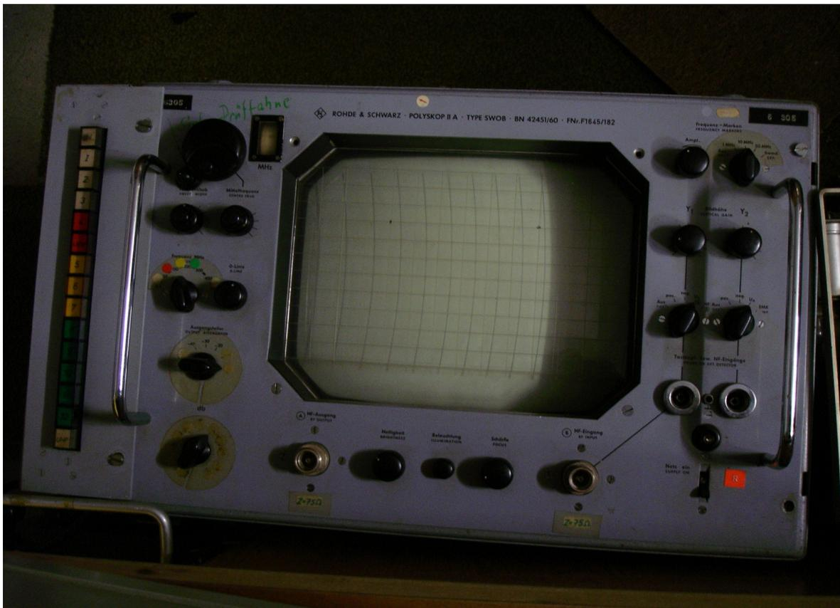
R&S Polyskop II A SWOB Wobbelsender/sichtgerät 0,5 bis 1200 MHz, Z=75 Ohm, ohne Tastköpfe
